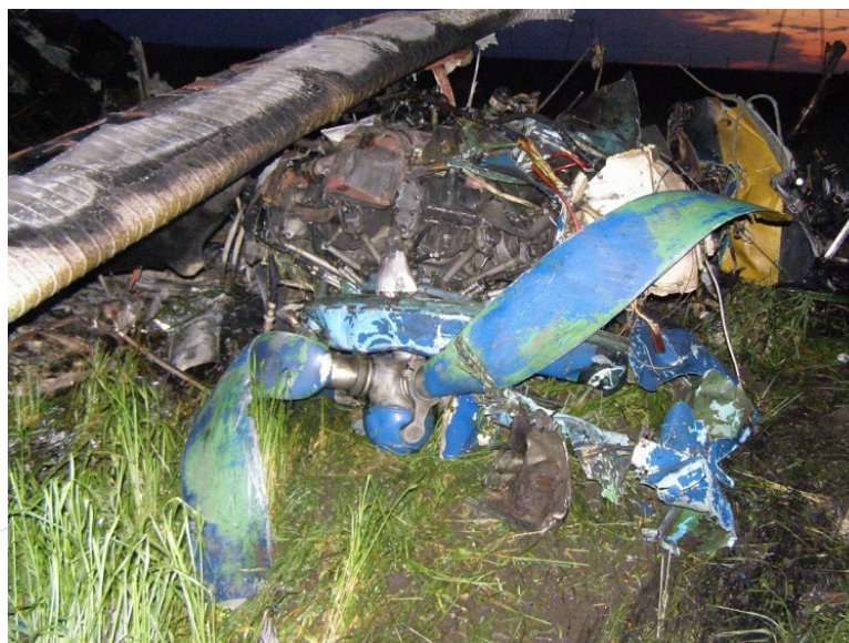
Fig.7 Palele elicei deformate după accident
